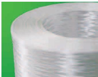
风能领域用玻璃纤维无捻粗纱与环氧树脂、乙烯基树脂、不饱和聚酯树脂等相容，所做的风能织物具有浸透速度快，强度、模量优异等特点，可使用E玻璃、TCR玻璃生产。泰山玻纤与AGY合作生产的高强高模S-1 HM玻璃纤维将继续满足风能产品对玻纤纱的更高要求。
